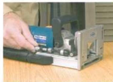
réglage rapide des différentes profondeurs de fraisage.
