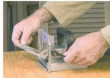
Guide frontal réglable en angle et en hauteur avec échelles graduées.
