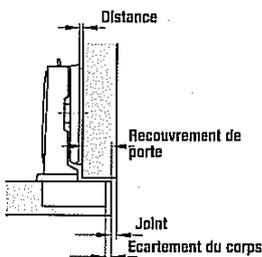
Les hauteurs de distance différentes des plaques de montage permettent des changements du recouvrement de porte. La dimension de la distance résulte de l'épaisseur de la plaque de montage. Le point de départ pour la détermination de la distance nécessaire est le type de pose désiré avec recouvrement de porte défini.
