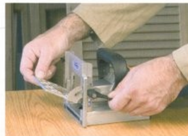
Guide frontal réglable en angle et en hauteur avec échelles graduées.
